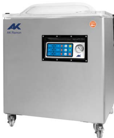
VP-800 Tapa curvada AB, AA. Bomba BUSCH 63m 3 /h.
