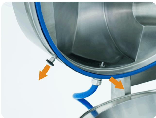
**Junta tapa-artera desmontable**, autoajustable con muelles.
