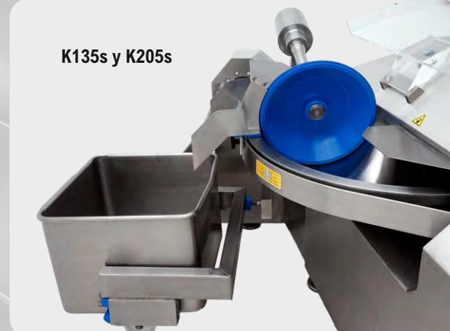
**Cargador hidráulico** para carro y brazo descargador hidráulico con **disco extractor motorizado, velocidad variable 50-150 rpm.**
