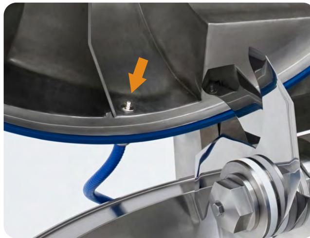
**Termómetro digital rápido y sensible**, con sensor extendido.
