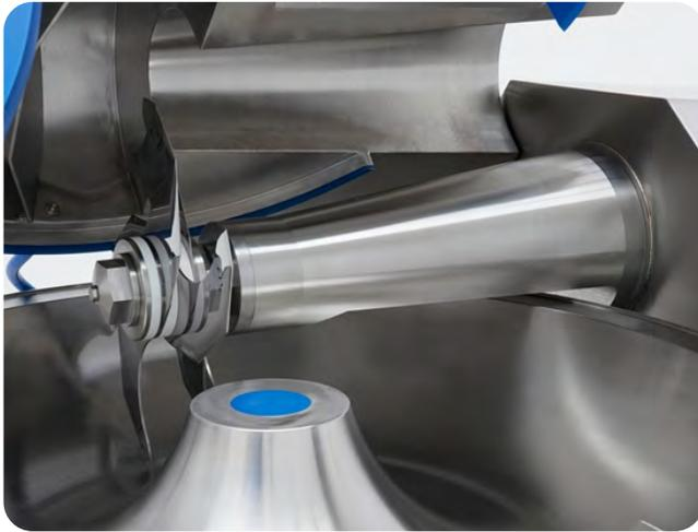
**Eje de cuchillas de gran diámetro**, muy fiable, con rodamientos y retenes de alta calidad.
