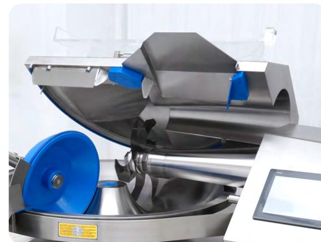
**Tapa de cuchillas motorizada** para elevación y descenso sin esfuerzo.
