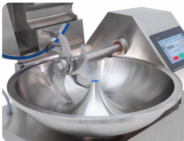
Opcional: cabezal de corte con **6 cuchillas**.
