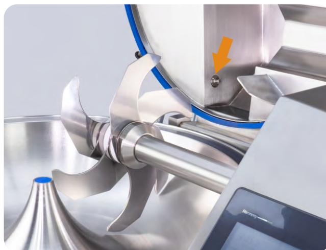
**Sensor de temperatura** situado en la cavidad de corte, donde se produce la máxima temperatura.
