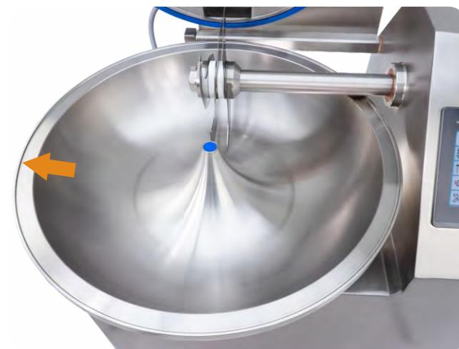
Artesa de **sólida fundición** de acero inox. Mecanizado de precisión CNC, **con borde**.
